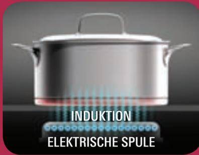
Umwandeln von magnetischer Energie in Wärme.
